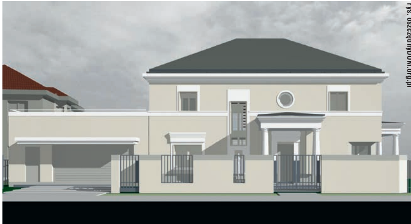
Elewacja północna. Rzuca się tu w oczy duża liczba. Ich łączna powierzchnia to 12,4 m 2 . Aby zbilansować powstające przez nie straty energii, konieczne było zastosowanie bardzo grubej izolacji cieplnej ścian i dachu
