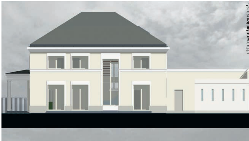
Elewacja południowa. Są tam trzy duże okna balkonowe i jedno nieotwieralne okno (typu fix) doświetlające jednocześnie dwie kondygnacje. Ich łączna powierzchnia to 31 m 2
